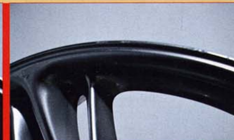
Mit einem speziellen Verfahren wurde diese Felge erwärmt und in die originale Form gewalzt
