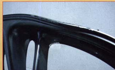
Mit einem speziellen Verfahren wurde diese Felge erwärmt und in die originale Form gewalzt
