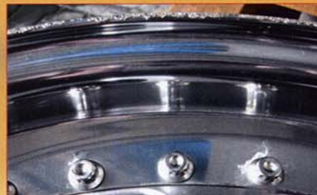
Eine mehrteilige Felge mit typischem Randsteinschaden und Lackunterwanderungen (vorher, nachher)
