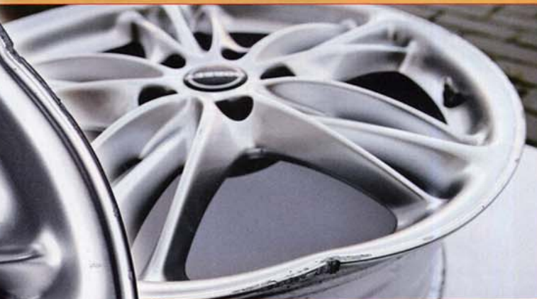
Eine mehrteilige Felge mit typischem Randsteinschaden und Lackunterwanderungen (vorher, nachher)
